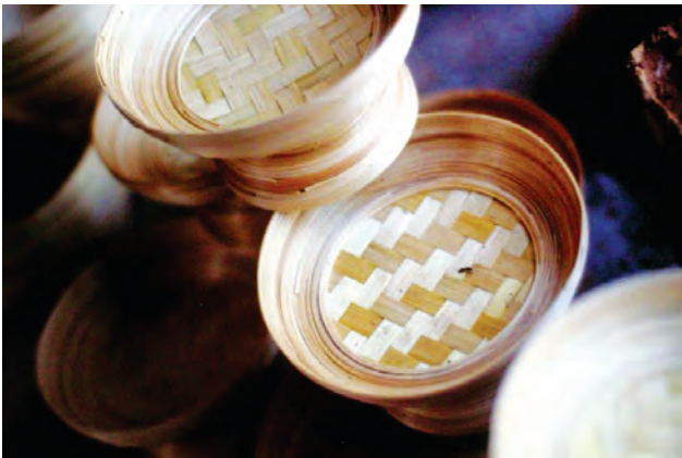
โครงสร้างเครื่องเงิน ที่ทำจากการขุด และสานไม้ไผ่
