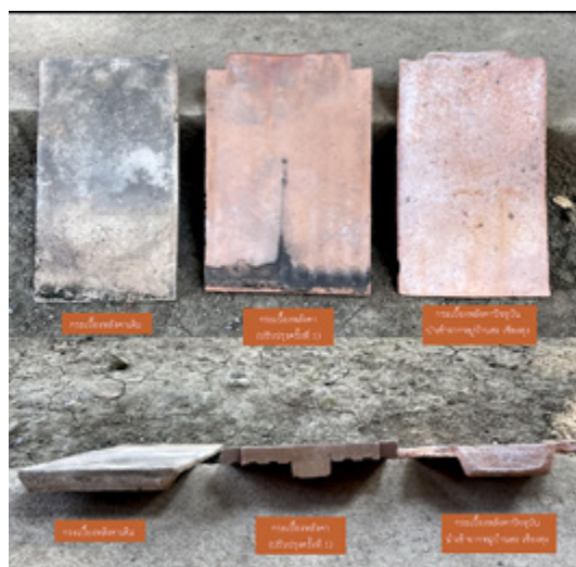
ภาพที่ 9 ภาพเปรียบเทียบกระเบื้องดินขอสามแบบ กระเบื้องเดิม กระเบื้องโรงงาน และกระเบื้องจากเมืองชะ (ภาพตามลำดับ)
